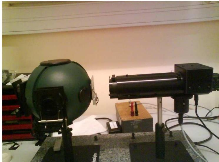
Fig.4.7. Spectromètre muni d'une sphère intégratrice
