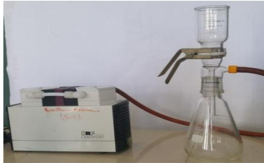
Figure 04 : Dispositif de filtration
