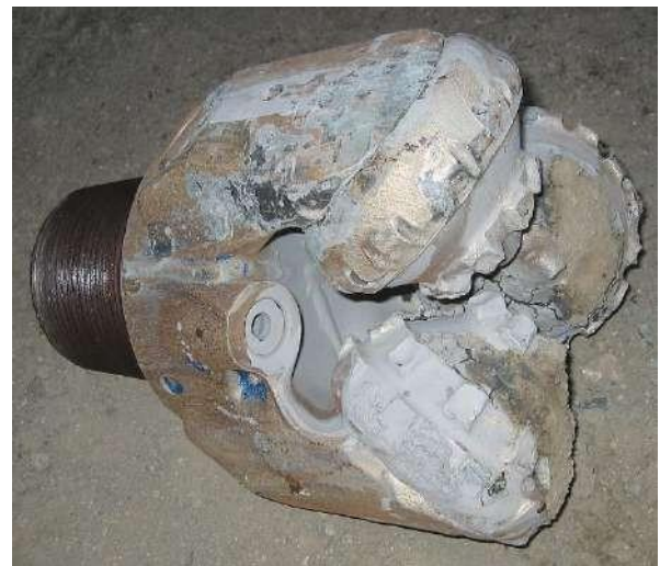
Figure III.4 : Un trépan usé.
