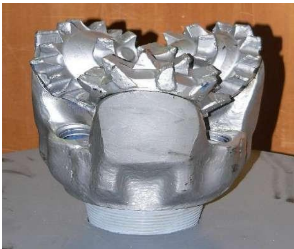
Figure III.3 : Trépan tricône typique, neuf.
