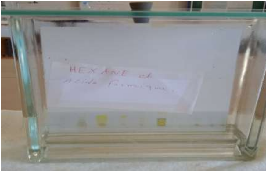
Figure 30 :chromatographie réalisée au laboratoire (130 ml Hexane +80ml Diethylether +20ml acide formique) (photo originale,2023) .
