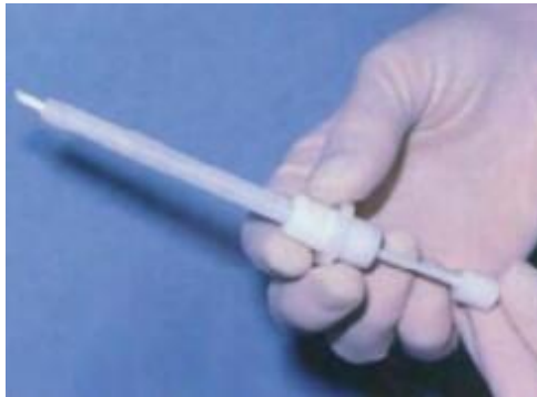
Figure 6 : Bâtonnet de glace carbonique monté en seringue
