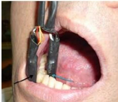
Figure 57: Essaiage du capteur fabriqué sur-mesure. La flèche noire représente la diode émettrice et la flèche bleue représente le photorécepteur
