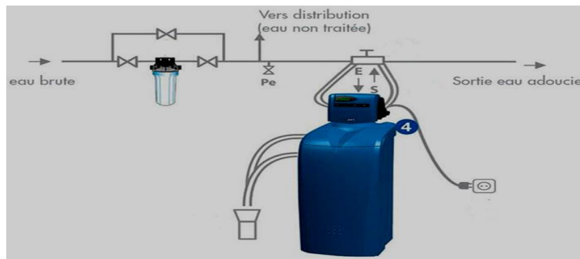
Figure (I-5) : Schéma explicatif de fonctionnement d'un adoucisseur d'eau [19]
