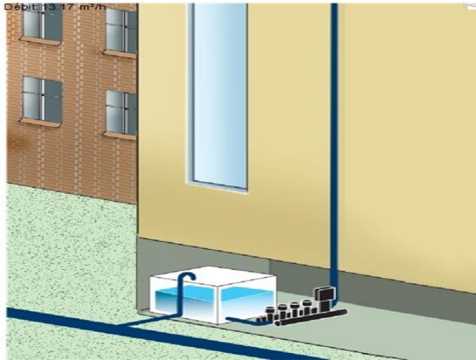
Figure (IV-16) : Installation d'une pompe de récupération
