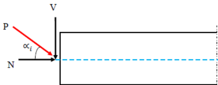
Figure-VIII-5: composantes de la force de précontrainte
