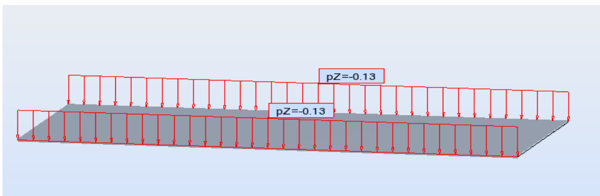
Figure-VI-8: chargement sous le poids des corniches.
