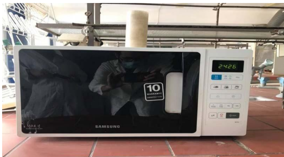
Image III.2 : Etape de mûrissement des HDLs par micro-onde .
