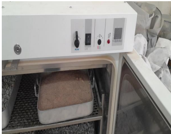
Figure II.2 : sable sèche a l'étuve.
