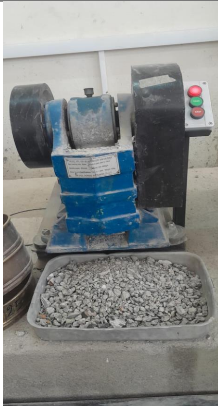
Figure II.6 : le gravier recycle 8/15 obtenu par le concassage.
