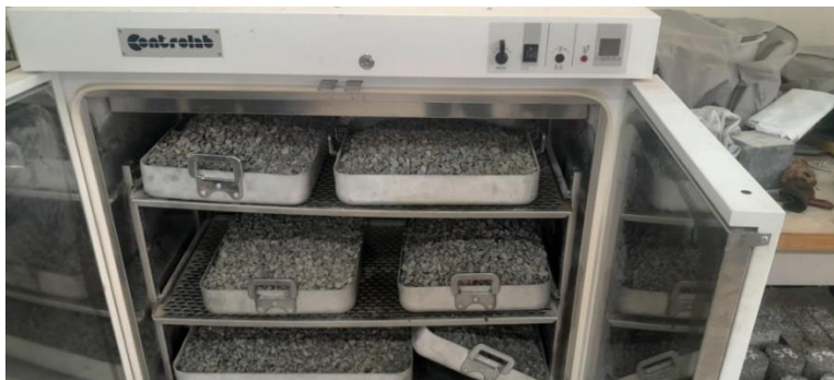
Figure II.3: Gravier naturel 8/15 sèche a l'étuve.
