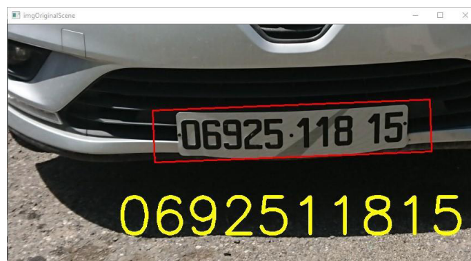
Figure 34 Illustration du résultat final de la lecture de la plaque grâce à OpenCV.
