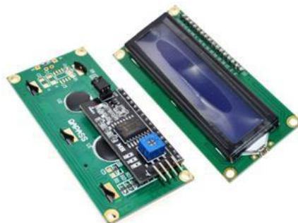
Figure 38 Afficheur LCD 2 lignes de 16 caractères, interface I2C
