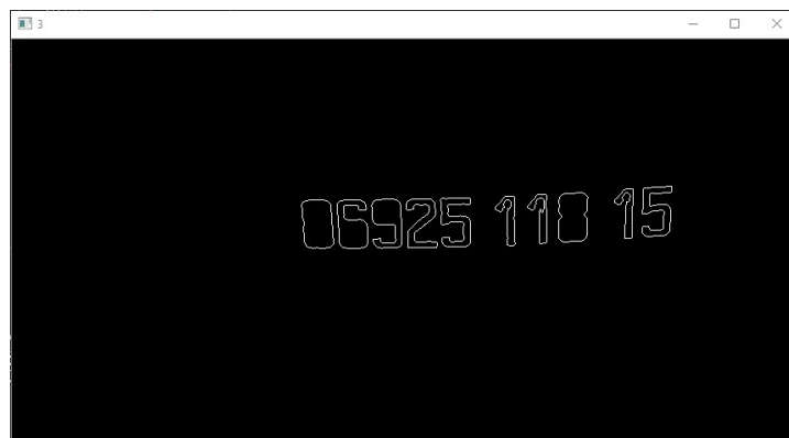
Figure 29 Contours des chiffres correspondants à la plaque d'immatriculation.
