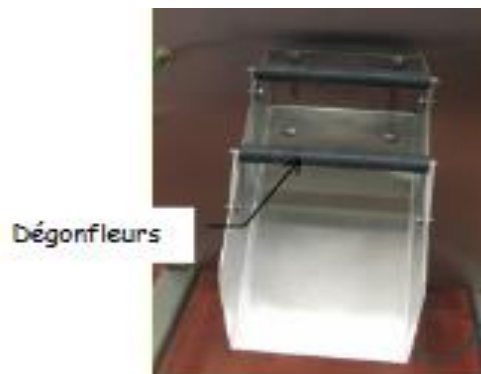
Figure 1.11 : photo réel de la Goulotte.
