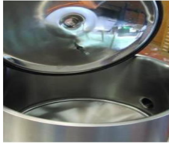
Figure 1.14 : Photo réelle de Capteur de Niveau.
