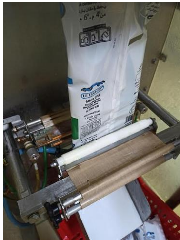
Figure 1.31 : Photo réelle de soudure horizontale
