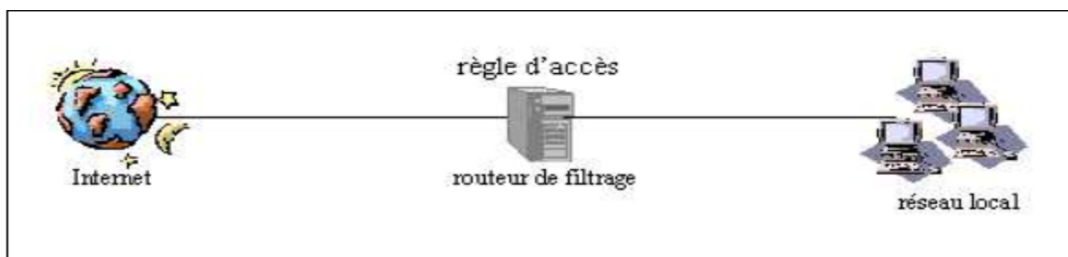
Figure 2.2 : Firewall avec routeur de filtrage
