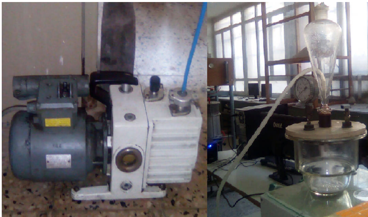
Figure II.6 : Pompe de séchage sous vide
