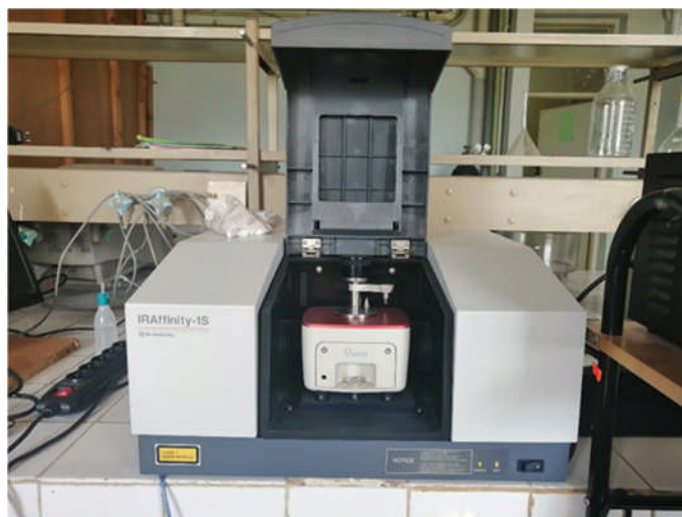
Figure II.11 : Appareil de spectroscopie infrarouge de laboratoire de chimie appliquée et génie chimique de l'UMMTO.
