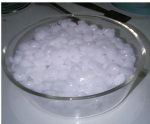
Figure II. 1 : Hydroxyde de sodium.
