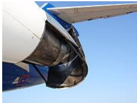
Figure.III.15 : Inverseur de poussée
