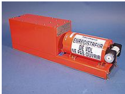
Figure : II.6. Boîte noire de type « enregistreur de vol ».
