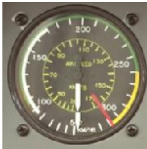
Figure : IV.2. Cadran d'un anémomètre de bord
