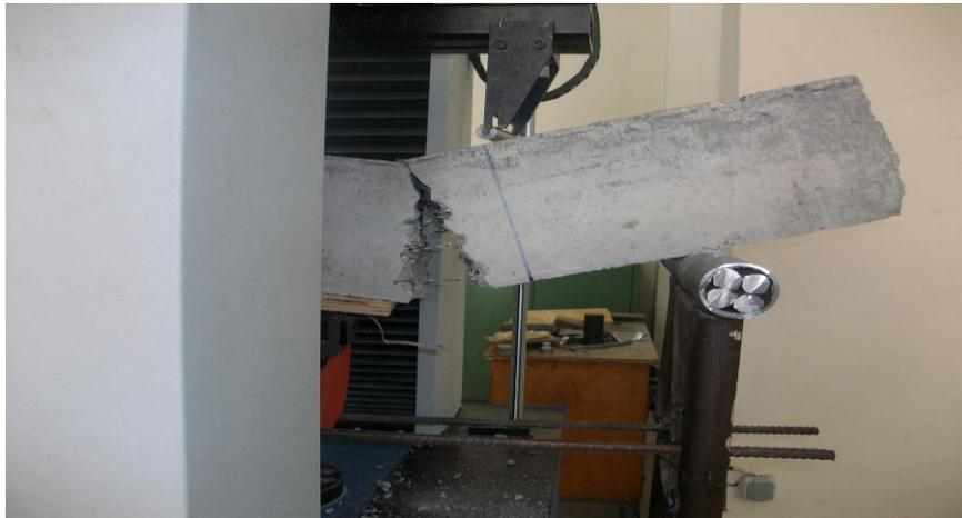
Figure VI.17 Exemple du mode de rupture des poutres lors des essais flexion 4-points pour la première série d'essais.
