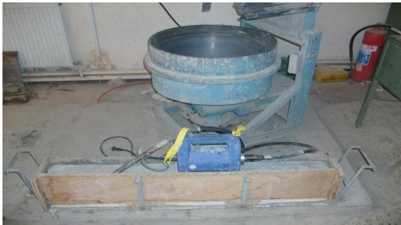
Figure VI.2 Malaxeur à axe vertical de capacité 65l et vibreur utilisée.
