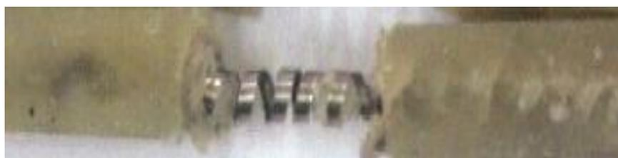
Figure II.2 préparation du système d'ancrage dans le moule à laide de la résine.
