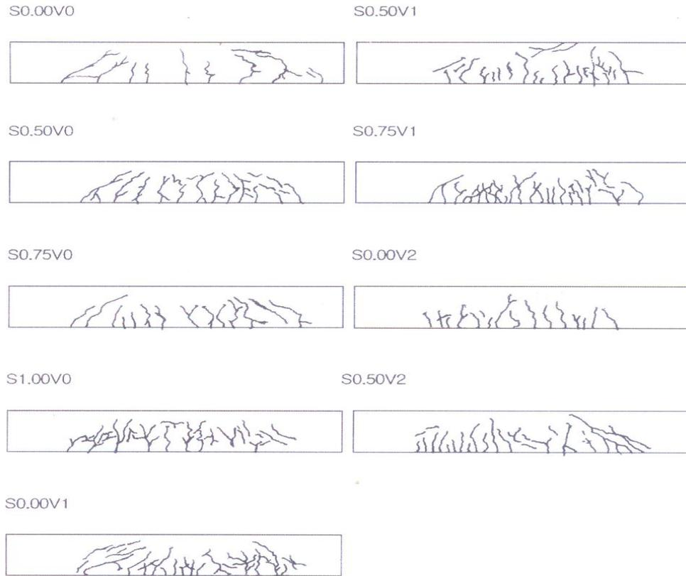
Figure I.54 Mode de fissuration pour les différentes poutres testées [71].
