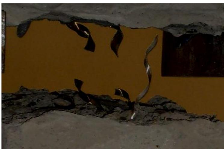
Etape 5 : Fibres sont rompues, les deux blocs de béton sont séparés.
