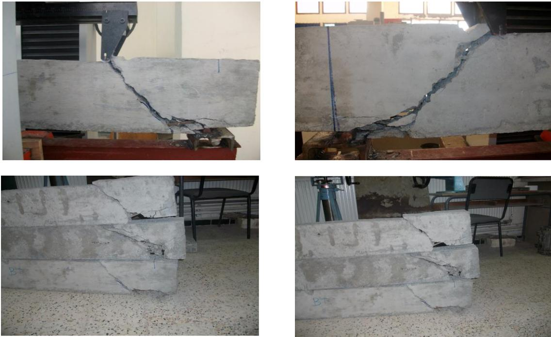
Figure VI.20 Mode de rupture des poutres testées (série A et B) lors des essais flexion 4-points.
