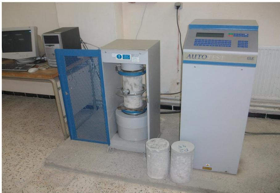
Figure VI.5 Presse de force (2000KN) AUTO test (ELE internationale).
