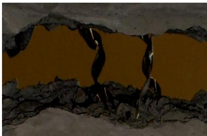
Etape 3 : Les fibres repris totalement la charge exercée sur l'éprouvette, ils s'étendent.
