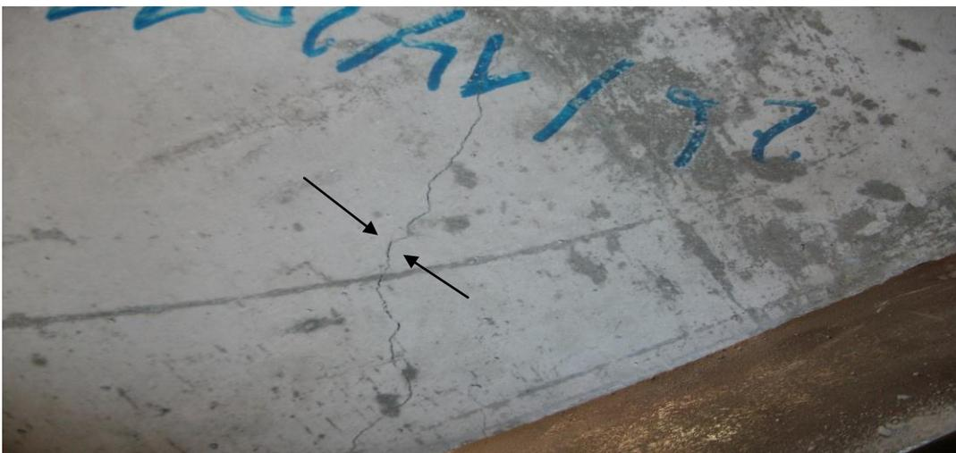
Figure VI. 25 Ouverture de fissures diagonales pour un force  $F= 79.572$  KN.
