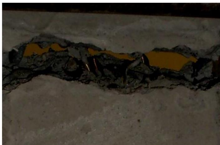
Etape 2 : Les deux blocs du béton sont retenus par les fibres.
