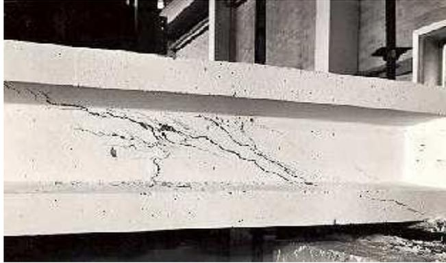
Figure I.72 Rupture d'une poutre par effort tranchant.
