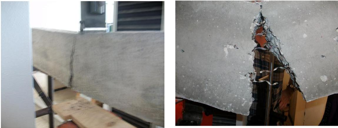
Figure VI.7 Exemple du mode de rupture des poutres lors des essais flexion 3-points.
