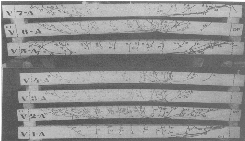
Figure I.46 Vue des poutres série A après les essais [70].
