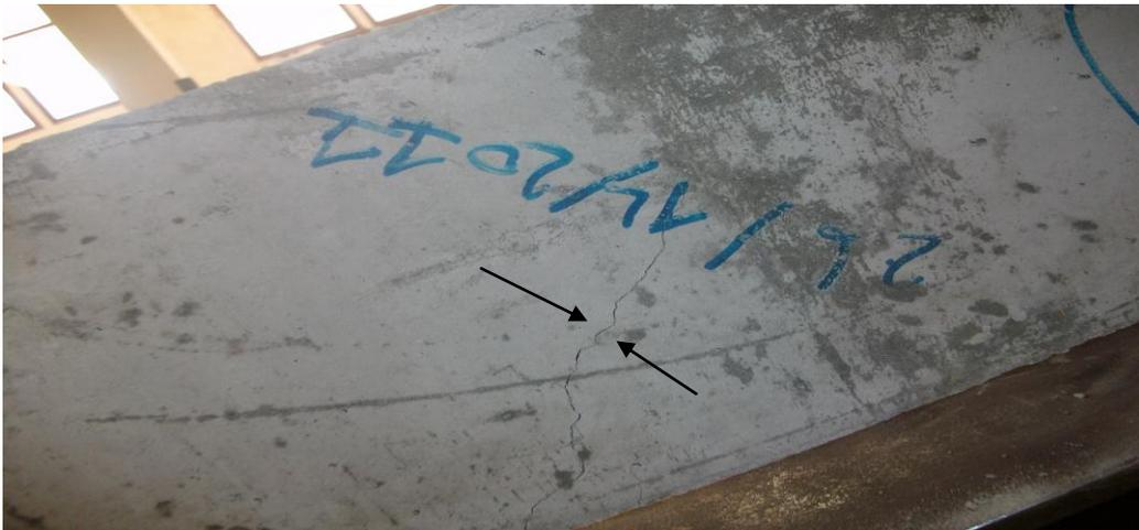
Figure VI.24 Ouverture de fissures diagonales pour un force  $F= 69,422$  KN.
