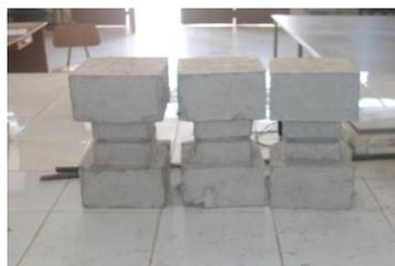
Figure V.2 Eprouvette en béton de fibres.
