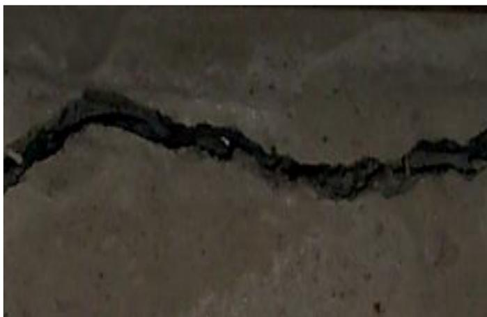
Etape 1 : Fissuration et rupture de la matrice en béton.
