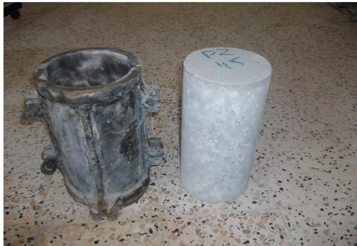
Figure VI.3 Eprouvette cylindrique de dimensions (15x30) cm<sup>2</sup>.
