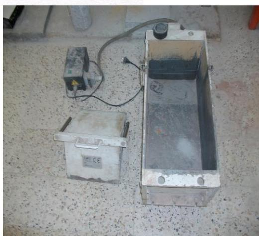
Figure IV.1 Le Maniabilimètre du LCPC.
