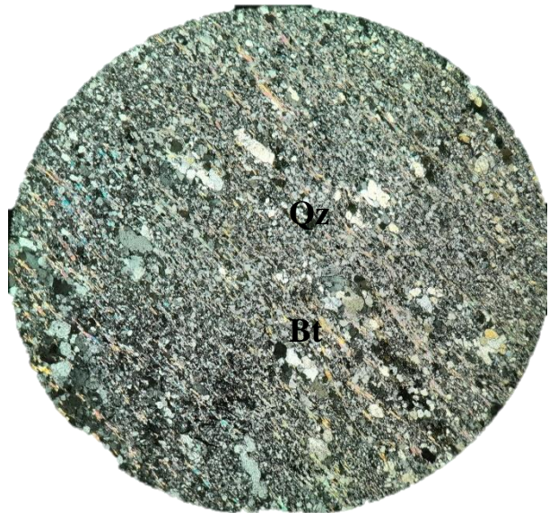
Figure 29: Un gneiss fin au microscope Gr4*10 LPA.
