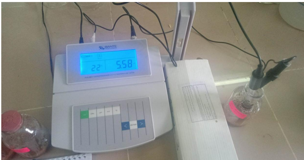
3. Mesure du PH avec un PH mètre
