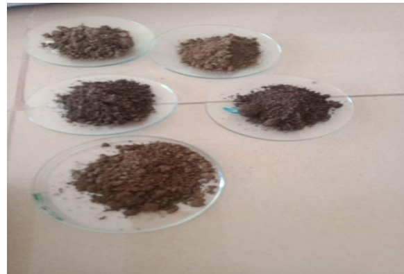
2. échantillons préparés et mis au four à 105 °C
