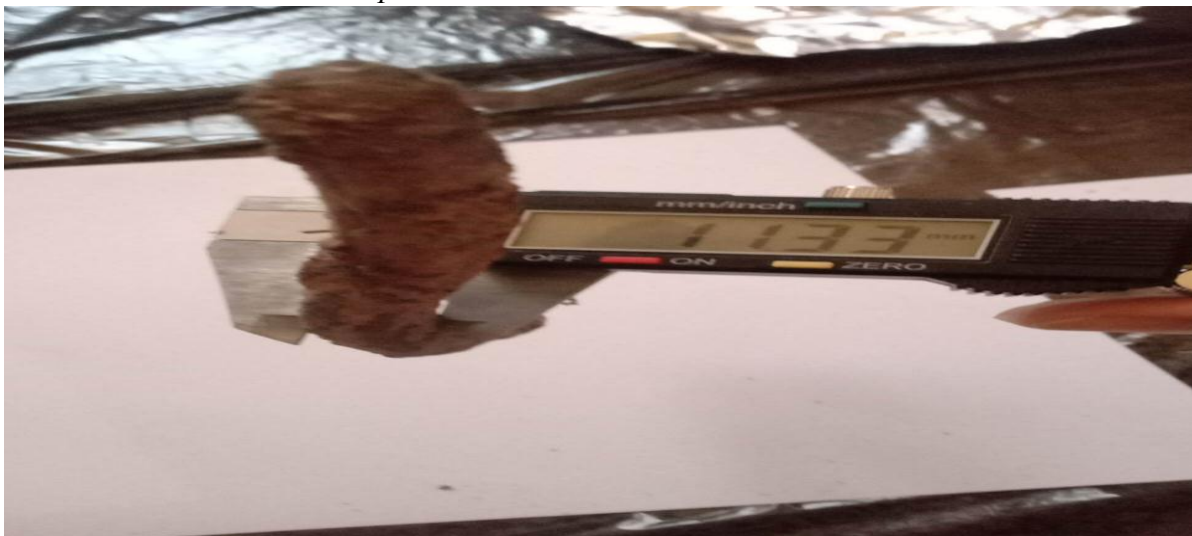
Figure 22 : Mesure du diamètre des racines avec un pied à coulisse électronique.
