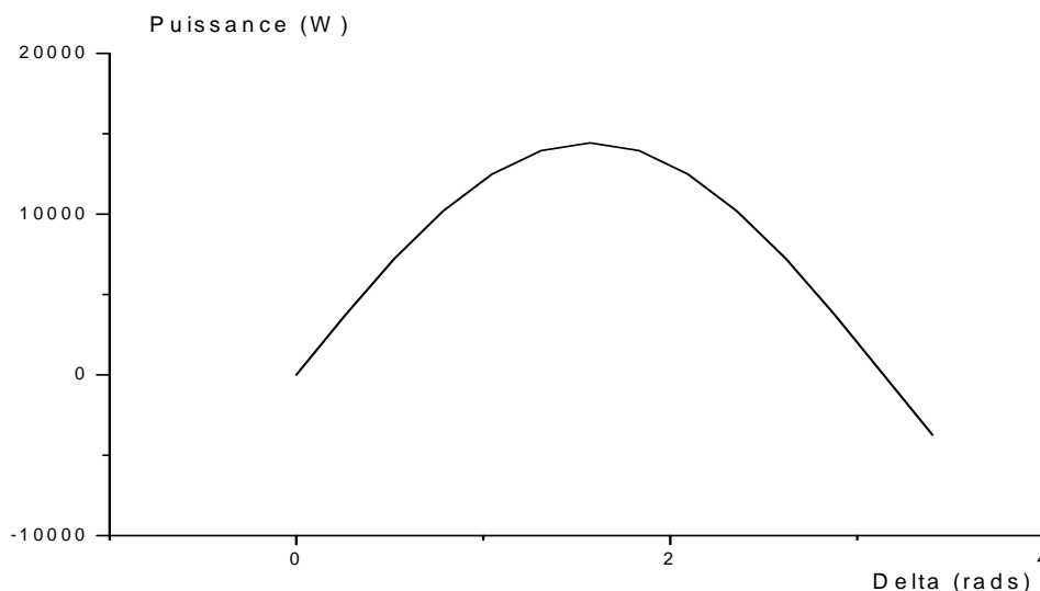
Figure IV.1: La caractéristique de la puissance active en fonction de l'angle interne delta.
