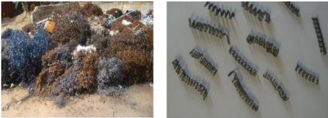
Figure 2.2 : Fibres issus des déchets d'usinage utilisé pour le matériau 2 [135]
