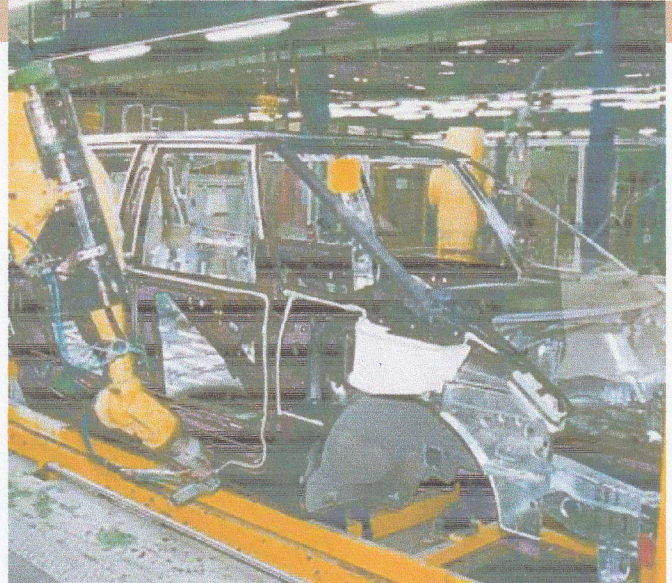
Les panneaux de carrosseries sont collés directement sur le châssis galvanisé.
