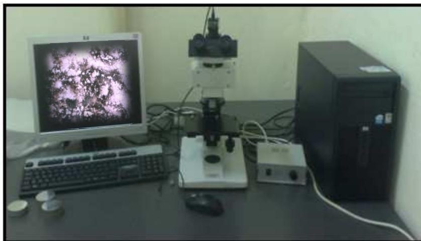
Figure 4.11 : Microscope optique.
