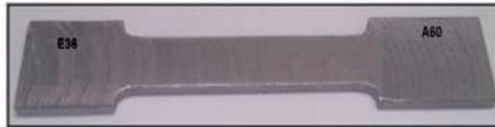
Figure 4.15 : Eprouvette de traction
