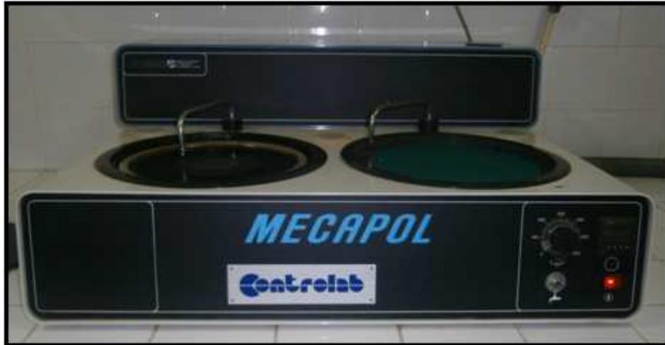
Figure 4.8: Polisseuse à deux disques.
