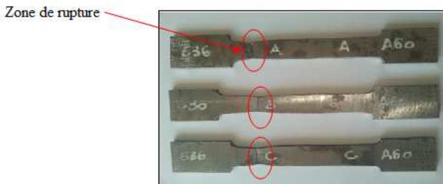
Figure 5.18 : Eprouvettes de traction après rupture pour les trois assemblages
