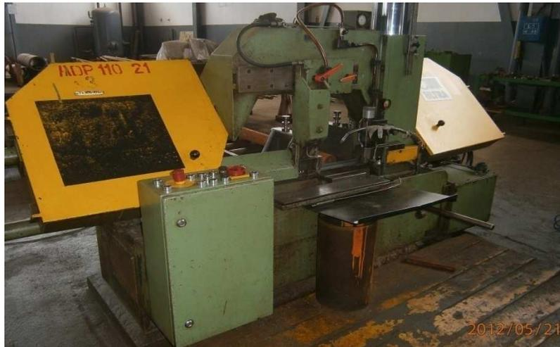
**Figure 4.1 :** Scie tronçonneuse
