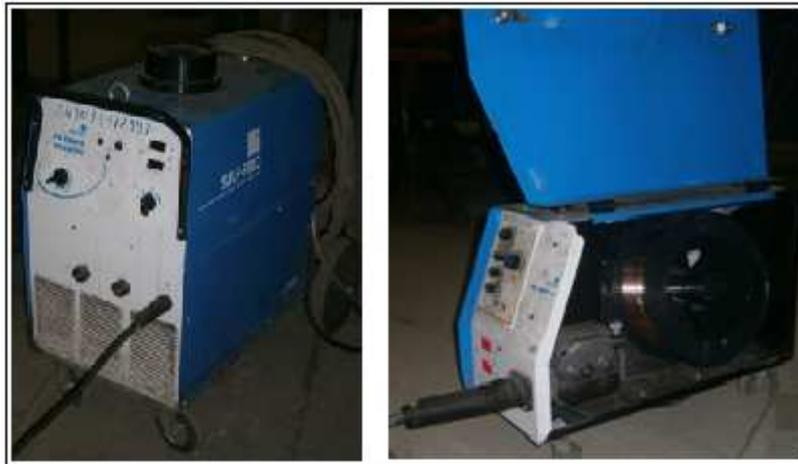
Figure 4.3 : Poste à soudé du procédé MAG (Metal Activ Gaz)
