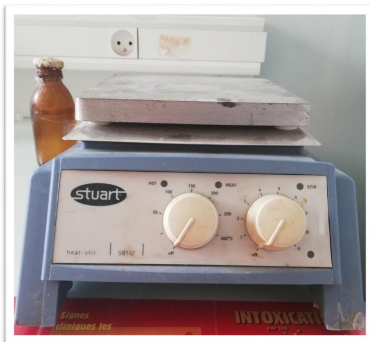
Figure 22 : Agitateur magnétique chauffant utilisé au Laboratoire de Toxicologie hôpital Nedir Mohamed Tizi-Ouzou.
