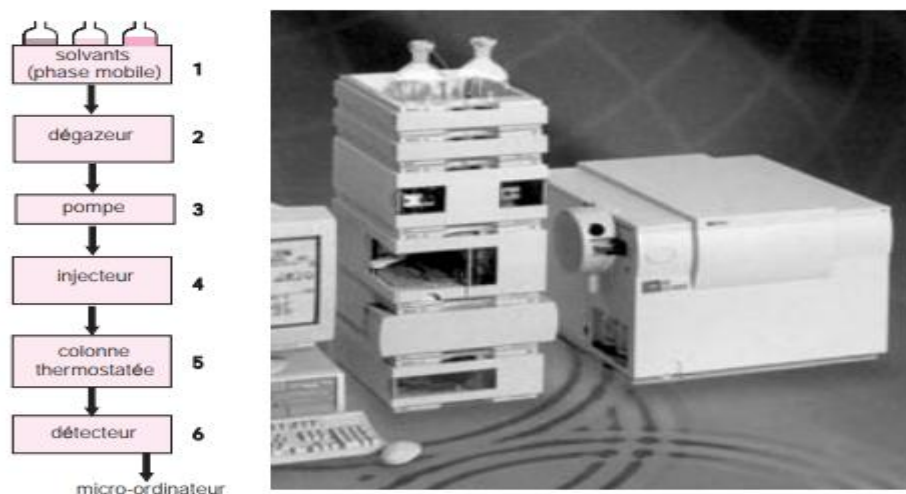
Figure 17 : Schéma d'une installation de CLHP (65).
