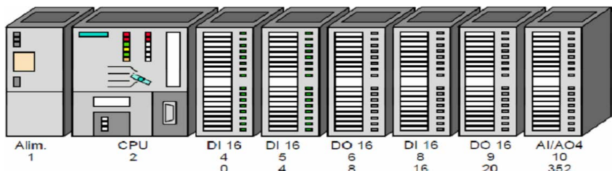
Figure III.5 : Vue générale de l'automate S7-300
