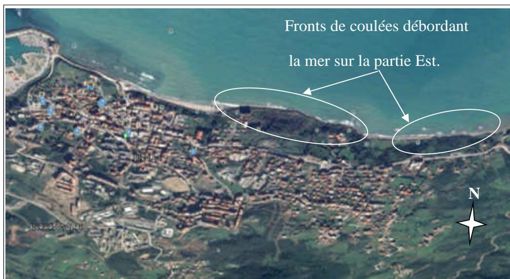
Figure 3.26. Vue aérienne montrant la morphologie des coulées terreuses sur la partie orientale.
