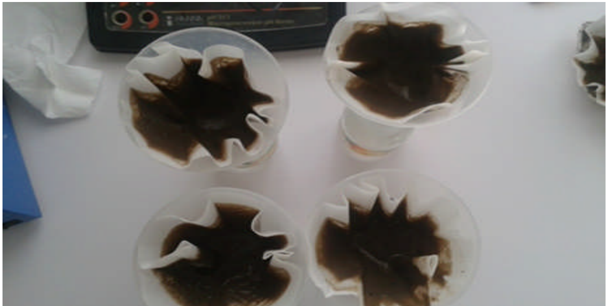
Figure 6 : Photo illustrant la détermination de la matière sèche
