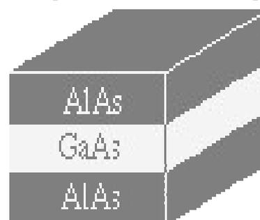
Fig(III.3) : puits quantique de couches de AlAs
