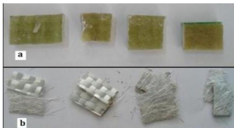
**Figure V.9** : a) Échantillons avant calcination, b) Échantillons après calcination.
