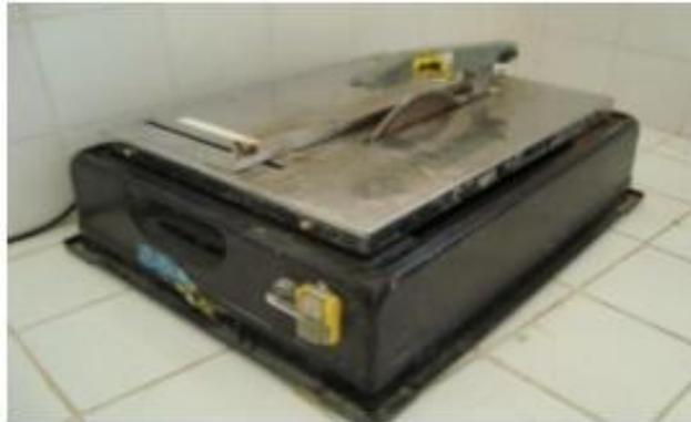
**Figure V.6** : Scie à disque diamanté.
