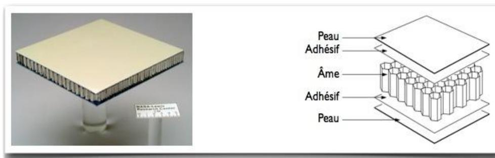
**Figure I.11** : Une structure en sandwich (image NASA) et ses constituants.
