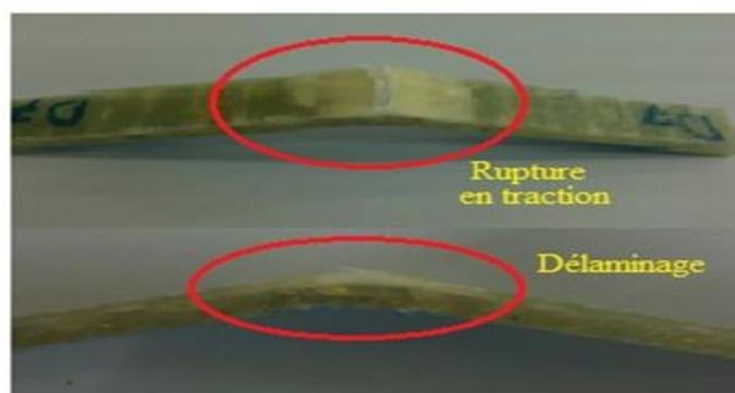
**Figure V. 35** : Eprouvettes rompues en flexion trois points.
