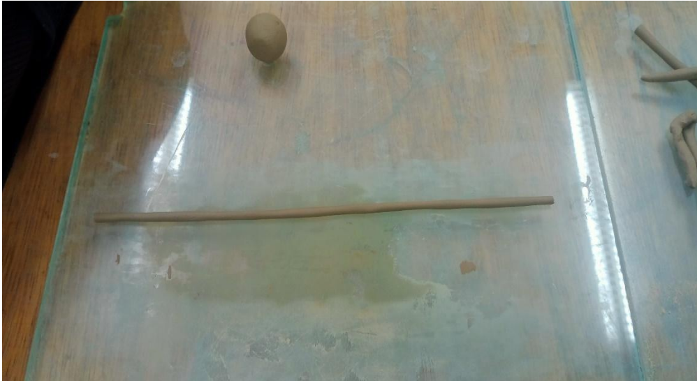
Figure IV.11 : Limite de plasticité.
