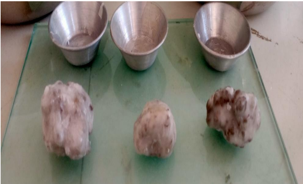
Figure IV.3 : Les échantillons de sol paraffinés.
