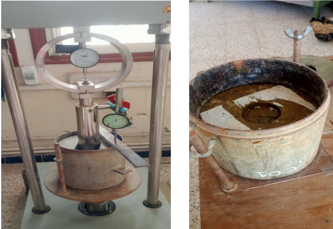
Figure IV.20 : L'essai CBR immédiat.
