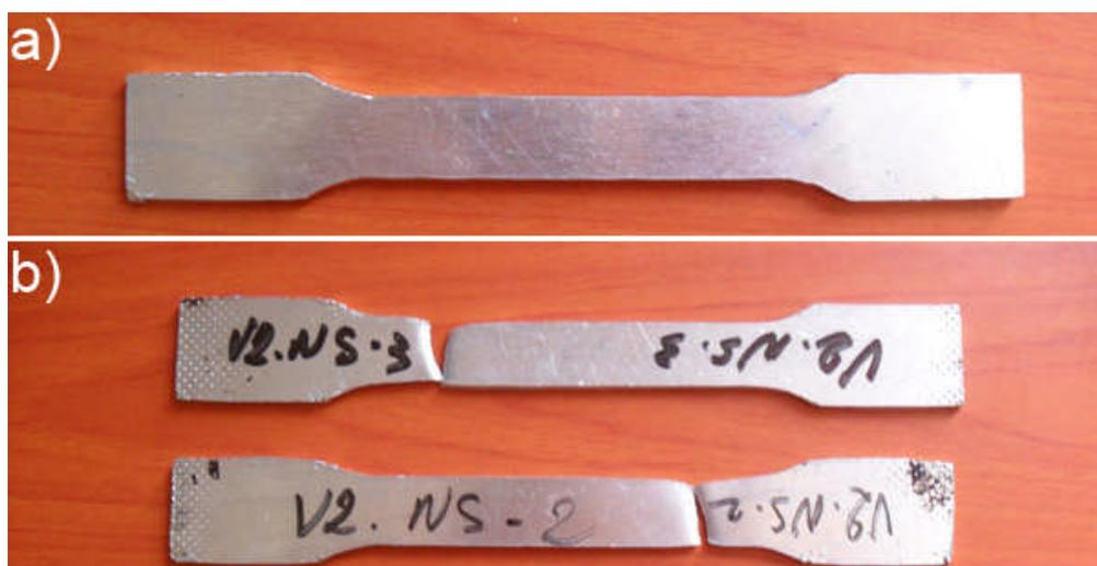
Figure III.19: Éprouvettes de traction non soudées : a) avant soudage, b) après soudage.
