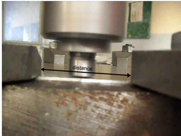
Figure III. 60 : la distance de sécurité entre les brides.
