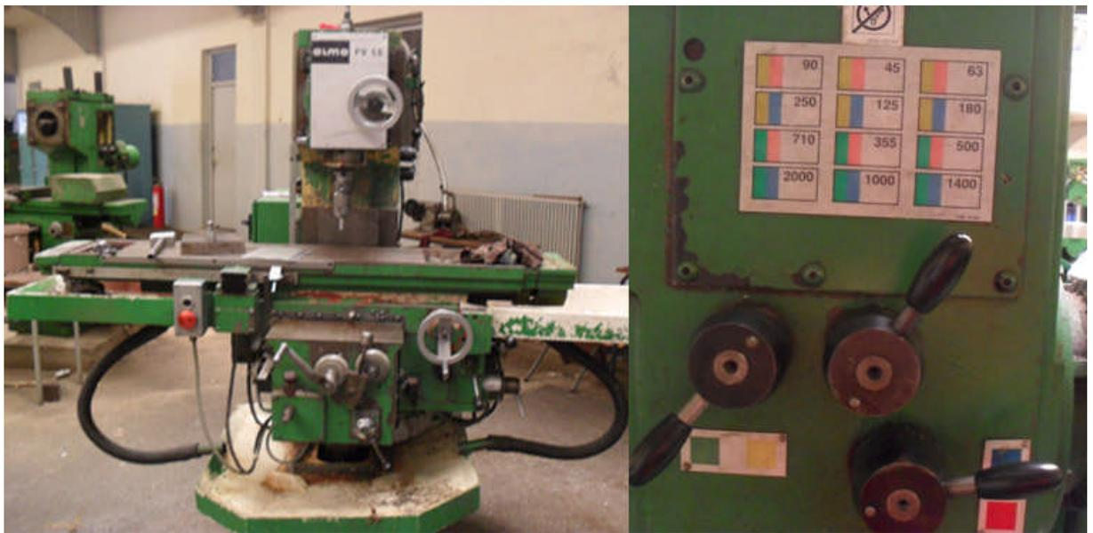
Figure III. 1 : fraiseuse verticale semi-automatique.
