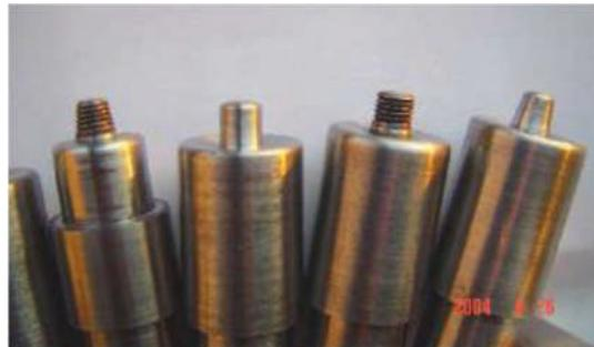
Figure II. 6 : Configurations d'outils utilisés pour déterminer l'effet de la géométrie du pion sur la résistance en traction des joints SFM (Zhao, Lin et al. 2005)
