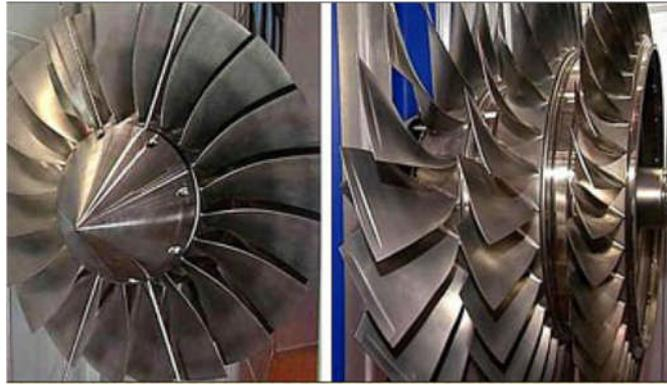
Figure I. 18 : Aubes de turbine soudées par friction (source: TWI)
