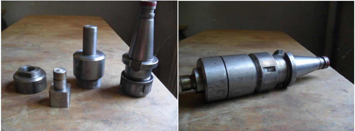
*Figure III. 8 : outil de soudage FSW.*
