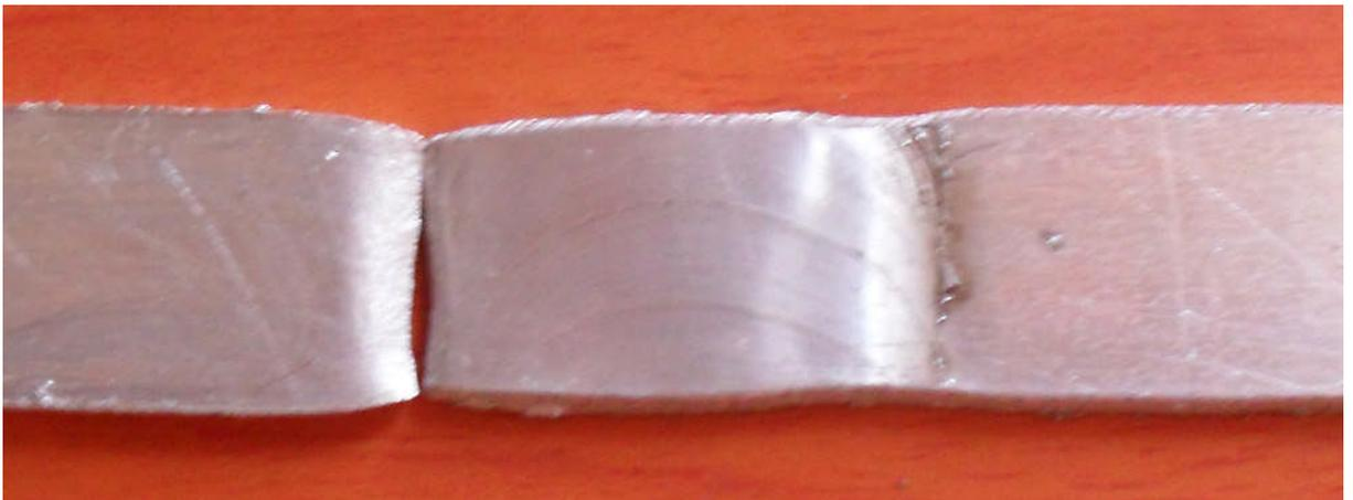
Figure III.21: Agrandissement du cordon de l'éprouvette rompue.
