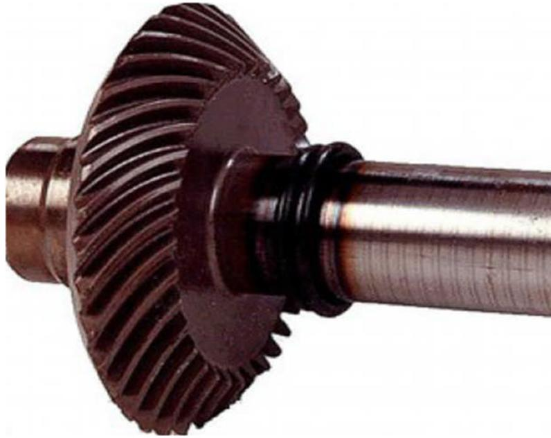
Figure I. 25 : Engrenage soudé par soudage par friction
