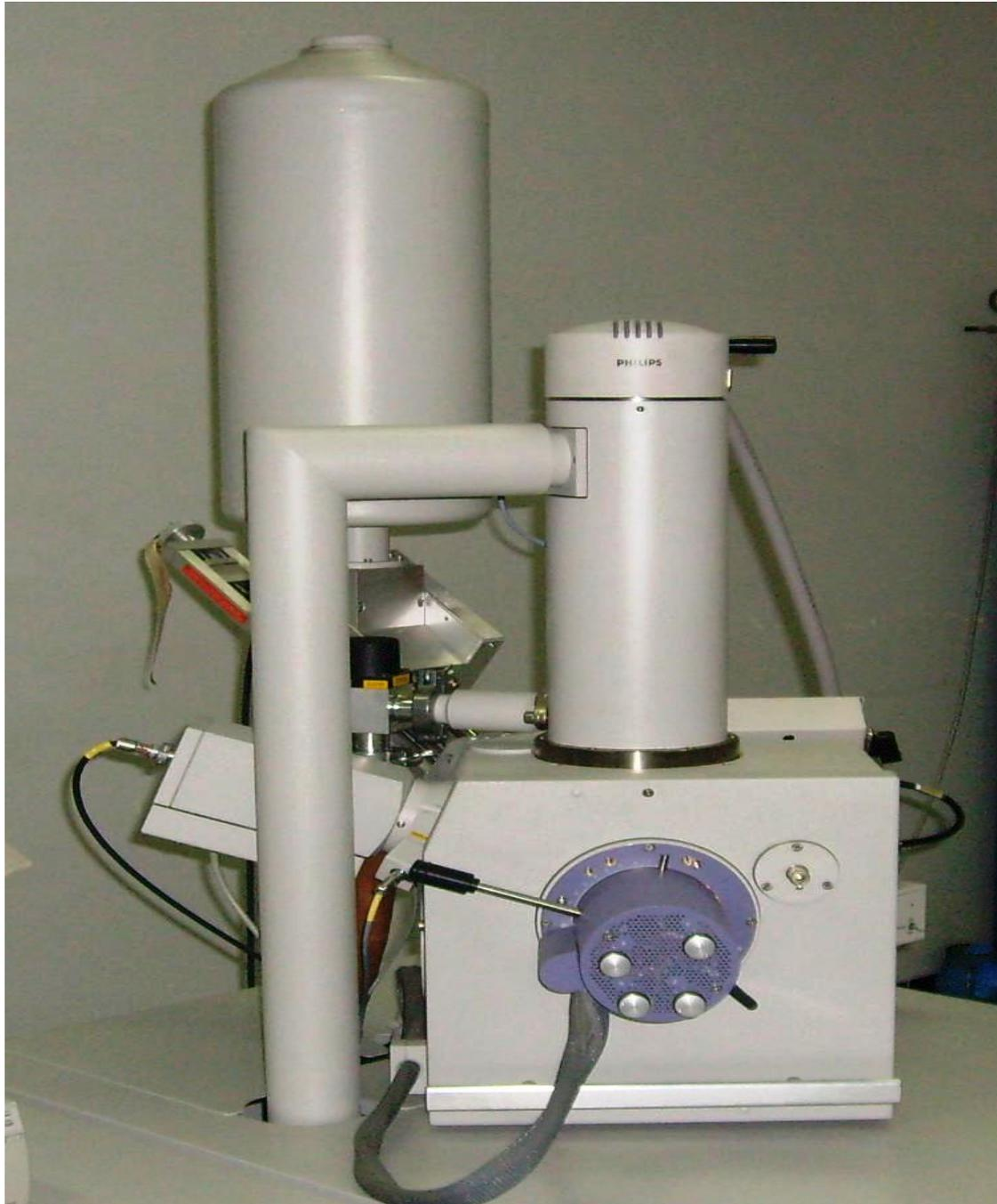
Figure III.13. Photographie du microscope électronique à balayage ESEM XL 30 Philips
