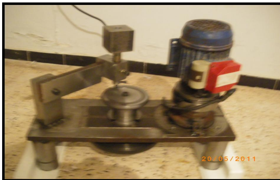
Figure 2.17 : Dispositif d'essais d'usure avec la configuration pion stationnaire-disque rotatif
