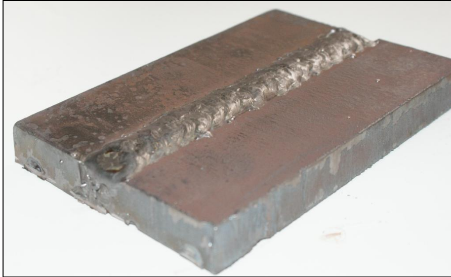
Figure 2.03 : La forme de la plaquette de la liaison bimétallique NAXTRA70/ E36 (après soudage)
