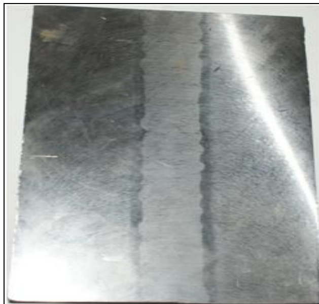
Figure 2.04 : La forme de la plaquette de la liaison bimétallique NAXTRA70/ E36 (après fraisage)
