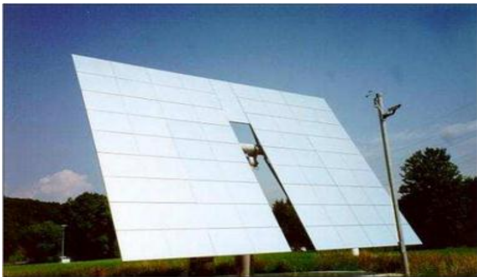
Figure II 6 : Héliostat en verre /métal à facettes.
