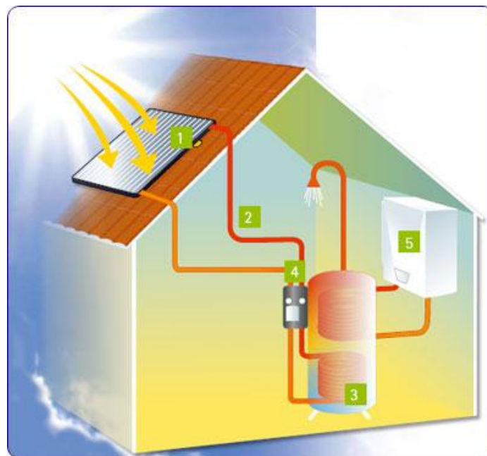
Figure I 24 : Chauffage à eau solaire.
