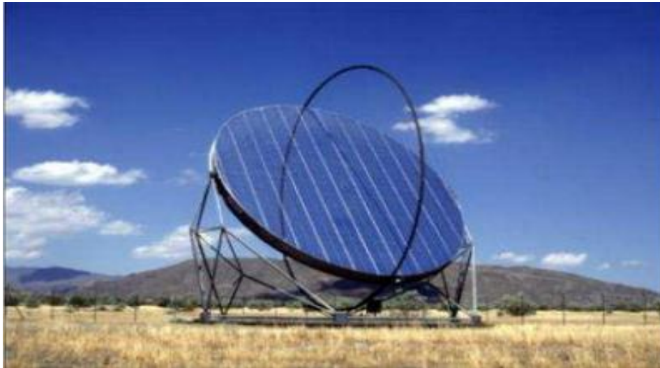
Figure II 7 : Héliostat à membrane.
