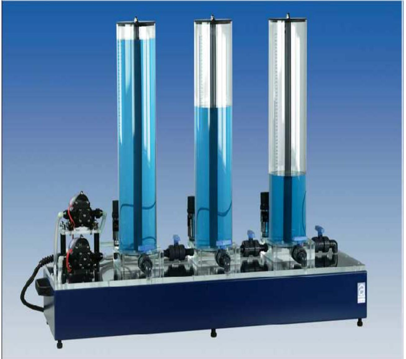
**Figure III.2** « The three tank system »
