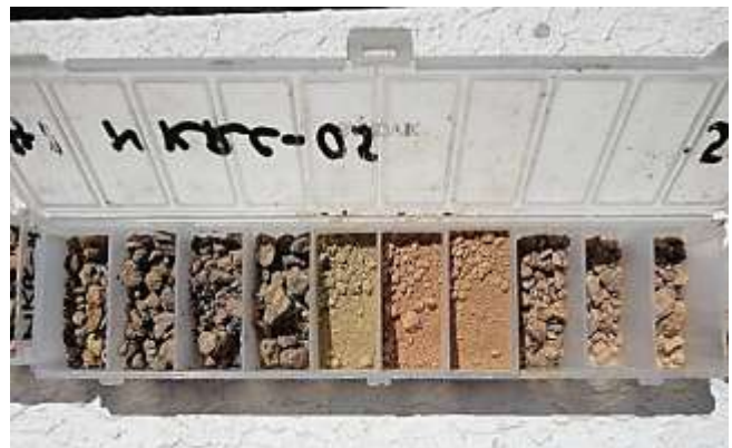
Figure IV.2. des échantillons remaniés d'un forage destructif (gexplore, 14 décembre 2016).
