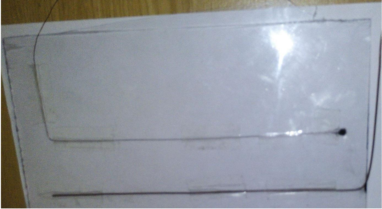
Figure IV.9- Photographie de l'actionneur OAUGDP : \phi_1 = 0,36 \text{ mm} , \phi_2 = 1,36 \text{ mm} , d = 4 \text{ cm}
