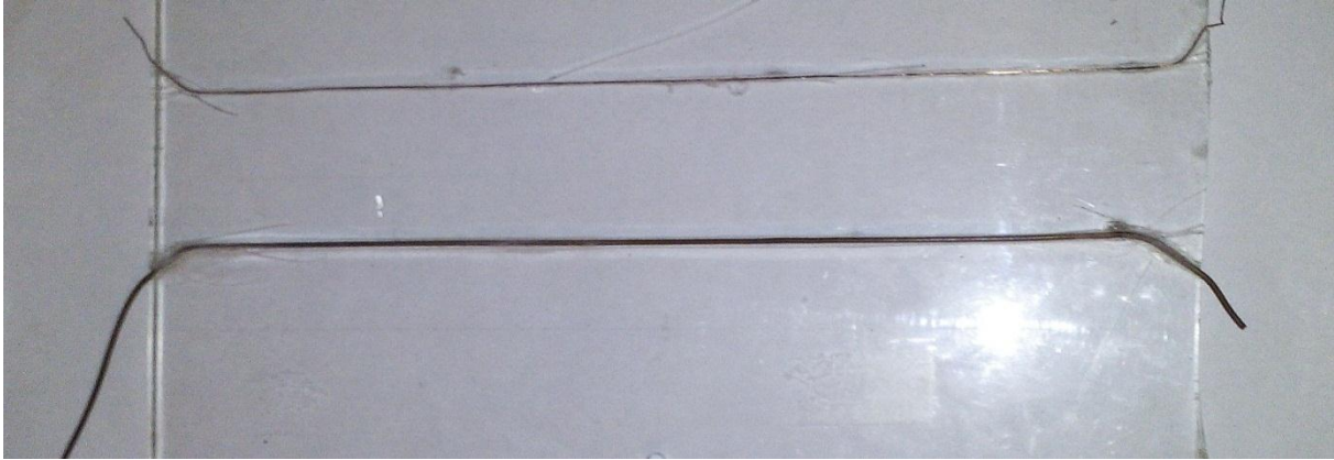
Figure IV.7- photographie en régime de décharge homogène de l'actionneur 6: \Phi_1 = 0,36 \text{ mm} , \Phi_2 = 1,36 \text{ mm} , d = 4 \text{ cm}
