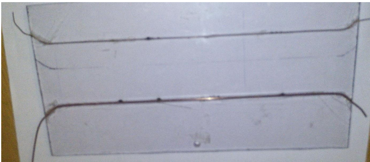
Figure IV.3- Photographie d'un actionneur plasma: \phi_1 = 0,61 \text{ mm} , \phi_2 = 1,36 \text{ mm} , d = 5 \text{ cm}
