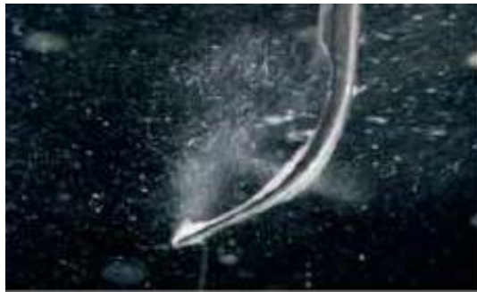
Figure 08 : Effets de la cavitation et microrépartition lorsque l'insert est immergé dans un liquide [4].
