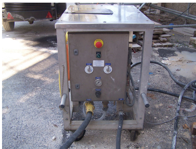
Photo 4.2. Appareil de mise en œuvre du sablage hydropneumatique.
