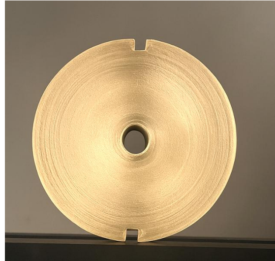
Fig. (III. III) : Visualisations du modèle sous le polariscope après traitement
