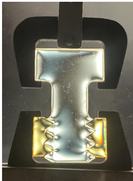
Fig. (III. IV) : Modèle étudié illustrant l'absence de contraintes résiduelles dès le début
