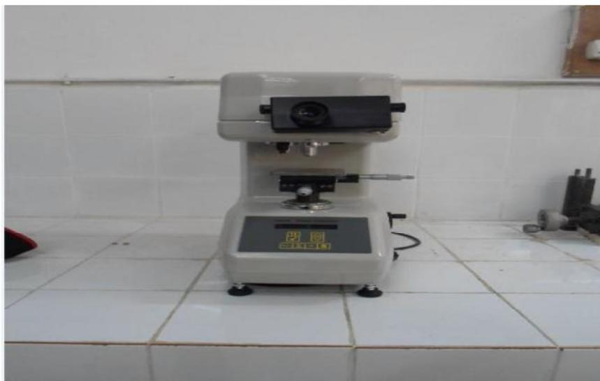
**Figure III.15 :** MICRODUROMETRE de marque ZWICK
