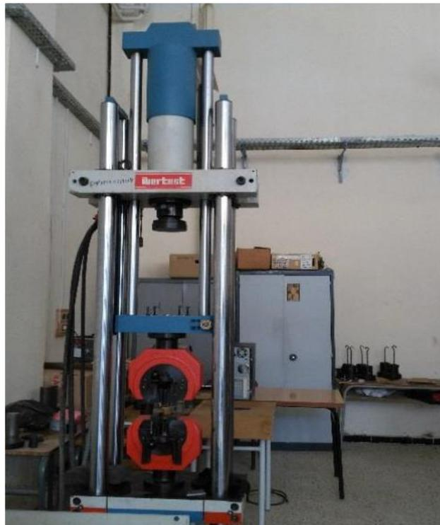
Figure III.14 : Machine de compression
