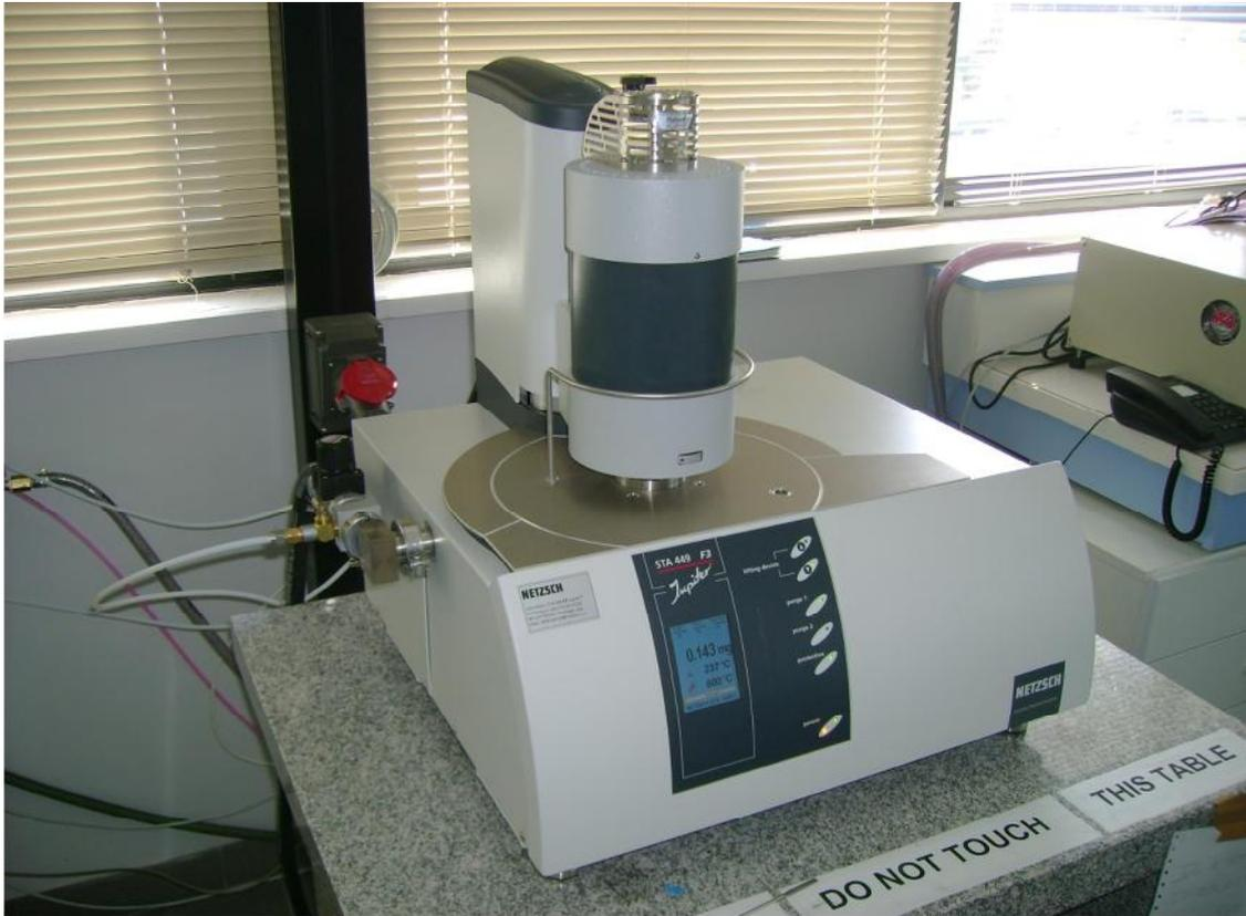
**Figure III.18 :** Dispositif d'analyse DSC et ATG
