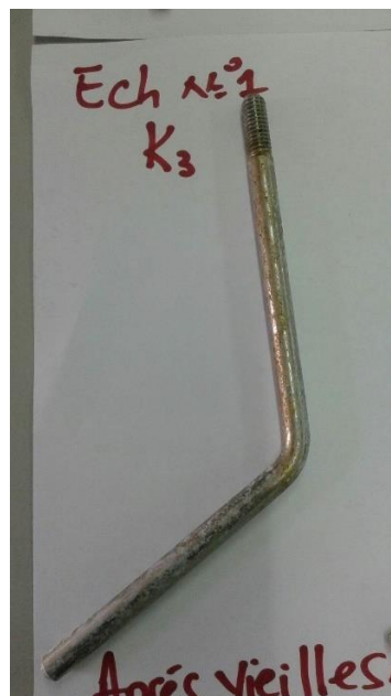
Figure III.1 : Corrosion de la corne d'éclateur type K3, après 7 jours dans un climat humide (98%) et à une température de 40°C.
