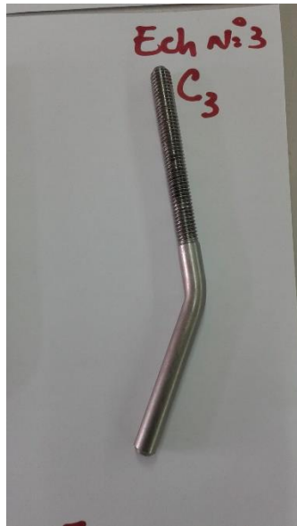
Figure III.2 : Corrosion d'une corne d'éclateur type K3 après 7 jours dans un climat humide (98%) et à une température de 40°C.
