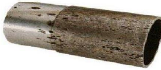
Figure I.3 : Corrosion par piqures d'un acier.
