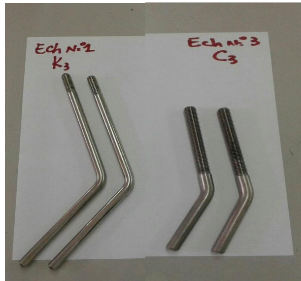
Figure II.1 : Présentation des cornes d'éclateurs type C3 et K3.
