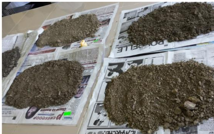
Figure13 : Séchage du sol
