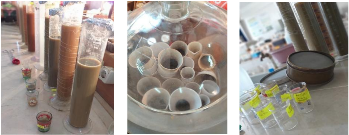
Figure 15: Prélèvement de différentes fractions granulométrique.
