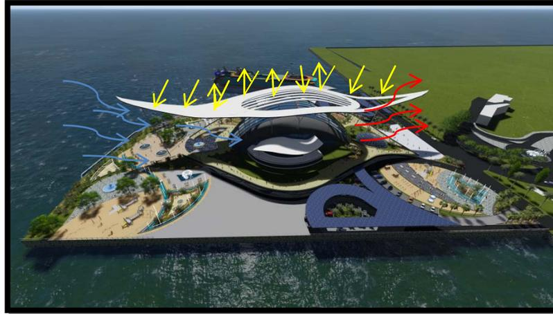
Figure 132 : protection solaire assurée par l'exo toiture
