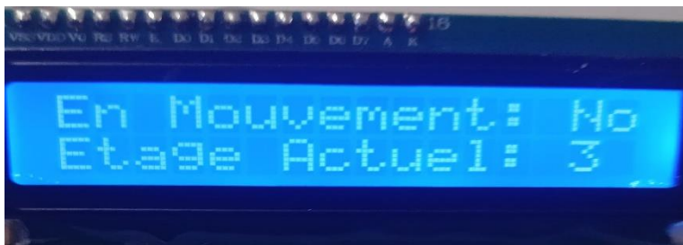
Figure 3.21 : Afficheur LCD indique l'étage actuelle.
