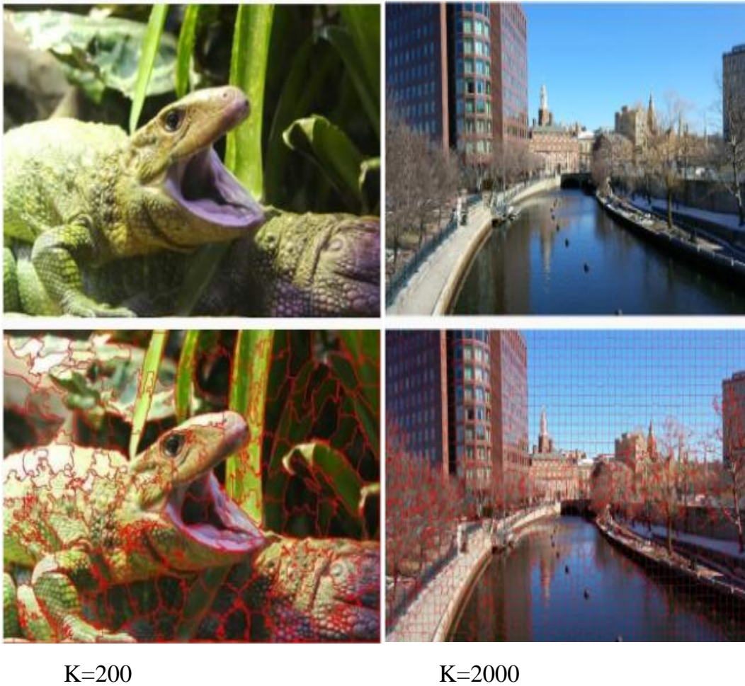
Figure II.5 : Exemple de superpexilisation par l'algorithme SLIC, les contours des superpixels sont représentés en rouge
