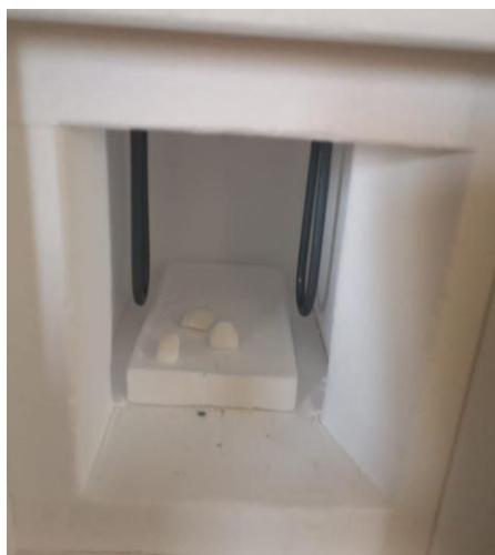
Fig 85. Sinterisation des 3 couronnes dans le four de sinterisation
