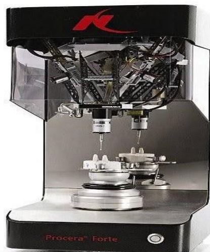
Fig 10. Enregistrement du M.P.U. en plâtre par le palpeur du Procera® Forte
