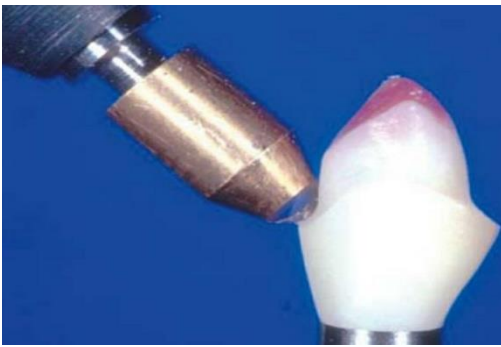
Figure1. Extrémité du bras du palpeur. [7]
