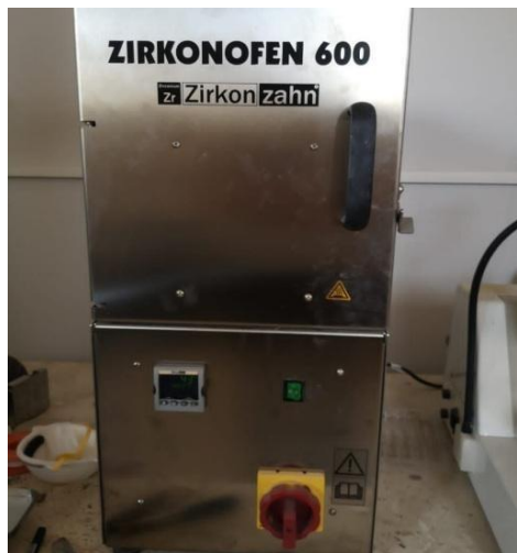
Fig 85. Sinterisation des 3 couronnes dans le four de sinterisation
