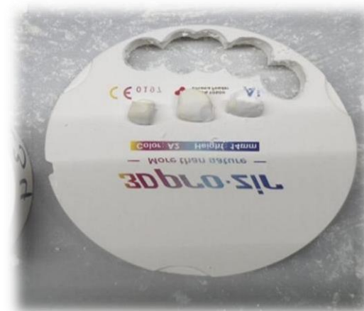
Fig 84. Couronnes usinées en état poreux au sein du Disque (nesting)
