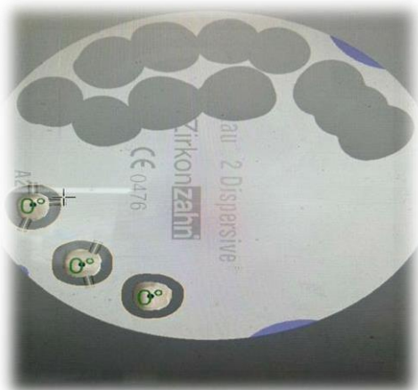
Fig 83 : pièces prothétiques usinées
