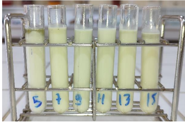
Figure 1. Test de stabilité à la centrifugation des émulsions à différent HLBm.
