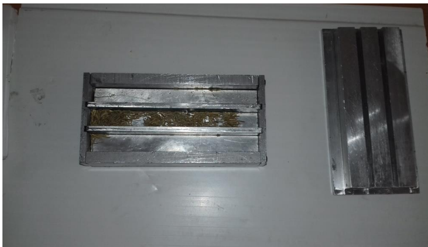
Figure V.4 : Moule en alliage d'aluminium.
