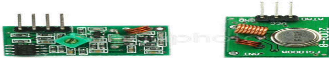
Figure13: Module émetteur (à droite); récepteur (à gauche)
