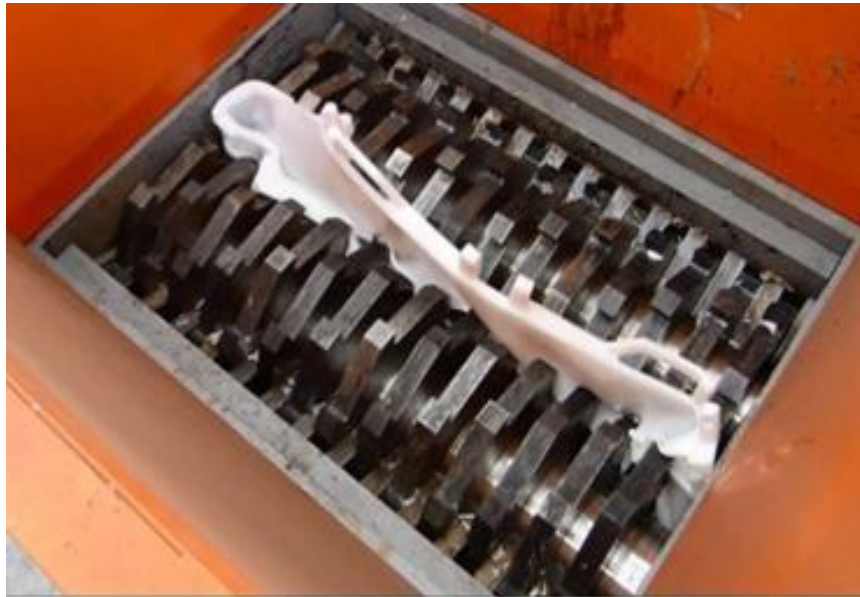
Figure IV.11 : Exemple d'un Broyeur
