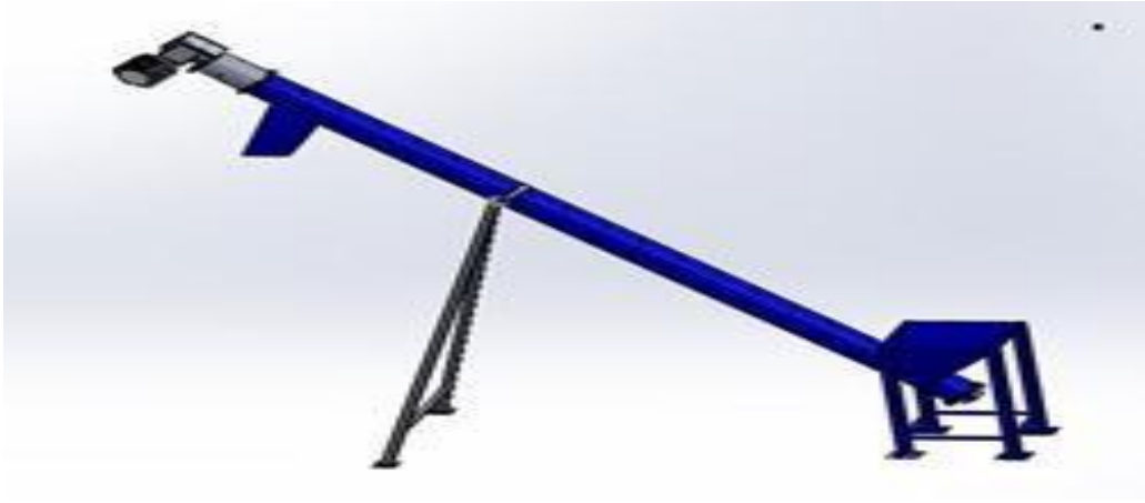
Figure IV.17 : Image présentée par SolidWorks du convoyeur à vis
