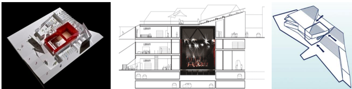
Figure 160: Volumétrie du projet montrant le principe de box in box
